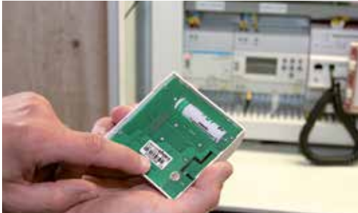
Varje temperatur- och fuktgivare har en egen identitet.
